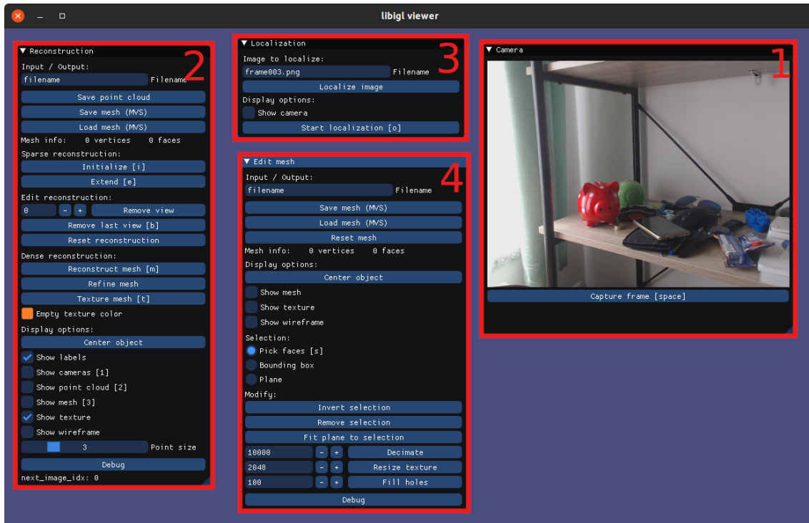
Slika 7: Zaslonski posnetek uporabniškega vmesnika aplikacije. Z rdečo obrobo so označeni posamezni moduli aplikacije. 1 - zajemanje slik, 2 - rekonstrukcija, 3 - lokalizacija kamere, 4 - urejanje modela.
